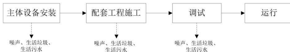
图 2 施工期工艺流程及产污节点图
