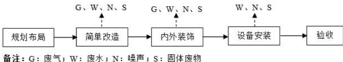
图 2-2 施工期工艺流程及产排污环节图
